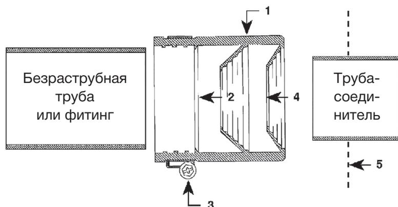
1. Установите соединитель (1) на конце трубы до касания ею разделительного кольца (2). Используйте отвертку для затяжки червячного хомута (3).
